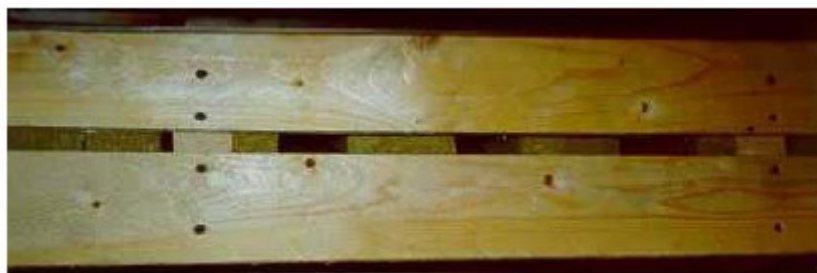
3.21. ábra – Az ásványgyapot csíkokkal megszakított szellőző légrés a valós vizsgálati modellen [Jukka et al. 2013]
