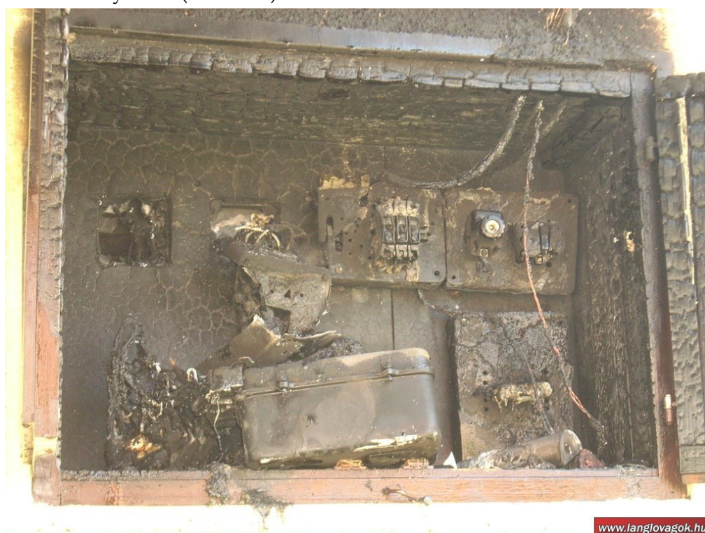
4.1. ábra – A tűzfészek – a kiégett villanyóraszekrény (forrás: www.langlovagok.hu )
