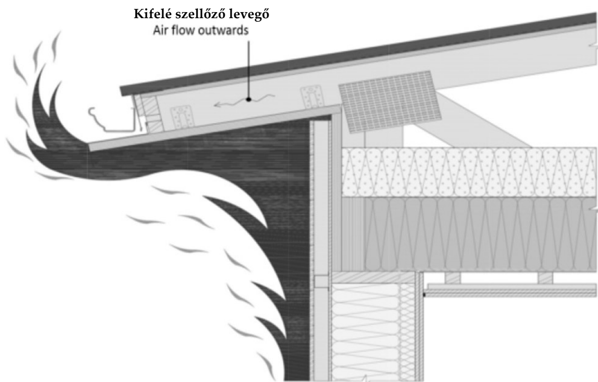
3.14. ábra – Csüngőeresz javasolt épületszerkezeti kialakítása [Mikkola, 2013]
